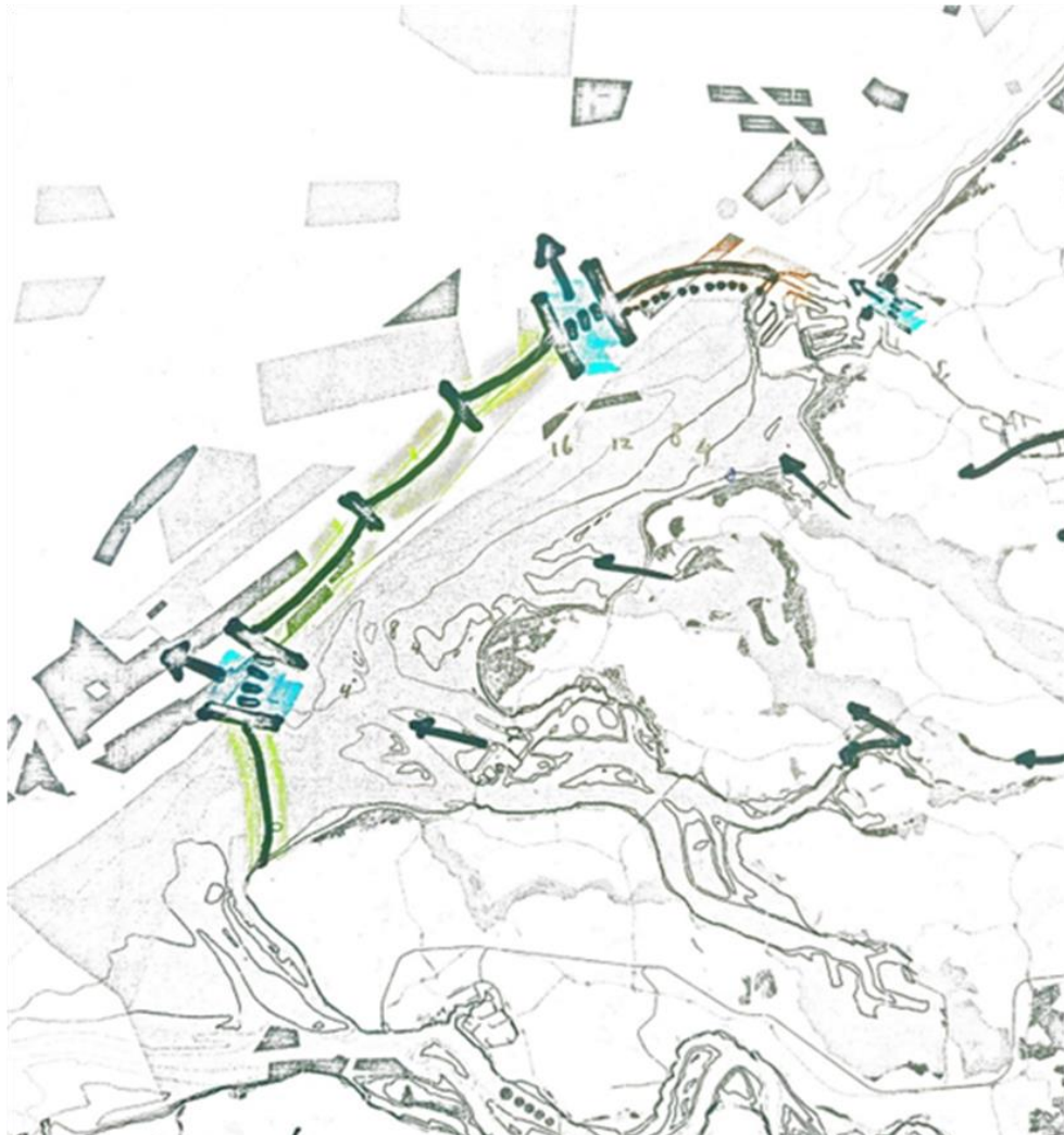
Figuur 5: Mogelijke layout van het kustbassin met pompgemalen – toereikend tot meer dan 5 meter zeespiegelstijging
